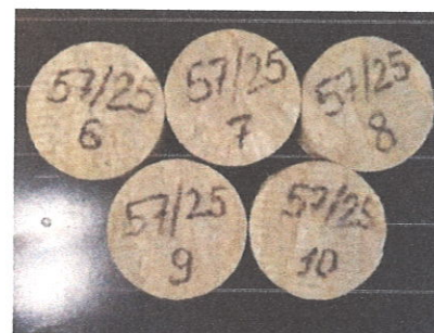
Рисунок 2 – Загальний вигляд дослідних зразків плит з мінеральної вати на синтетичному зв'язуючому марки «NT FasPRO 7,5» виробництва ТОВ «НОВОТЕРМ»: №182/25 (1-5)
