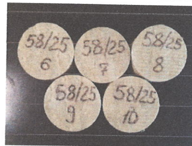
Рисунок 6 – Загальний вигляд дослідних зразків плит з мінеральної вати на синтетичному зв'язуючому марки «NT Air» виробництва ТОВ «НОВОТЕРМ»: №186/25 (1-5)
