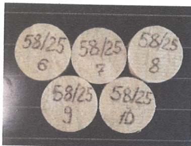
Рисунок 5 – Загальний вигляд дослідних зразків плит з мінеральної вати на синтетичному зв'язуючому марки «НТ Фасад 110» виробництва ТОВ «НОВОТЕРМ»: №185/25 (1-5)
