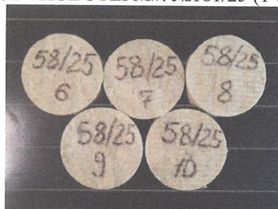
Рисунок 3 – Загальний вигляд дослідних зразків плит з мінеральної вати на синтетичному зв'язуючому марки «NT Fasad 7,5» виробництва ТОВ «НОВОТЕРМ»: №183/25 (1-5)
