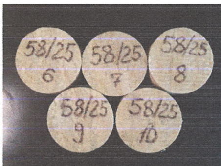
Рисунок 3 – Загальний вигляд дослідних зразків плит з мінеральної вати на синтетичному зв'язуючому марки «НТ Покрівля 115» виробництва ТОВ «НОВОТЕРМ»: №58/25 (6-10)
