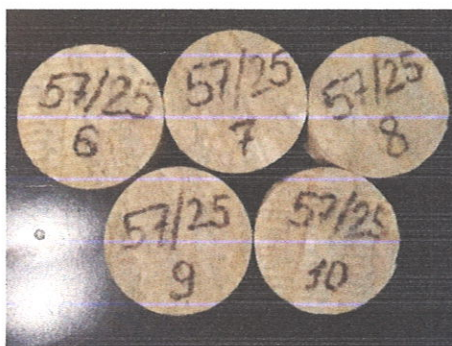
Рисунок 2 – Загальний вигляд дослідних зразків плит з мінеральної вати на синтетичному зв'язуючому марки «НТ Вент Фасад 90» виробництва ТОВ «НОВОТЕРМ»: №57/25 (6-10)
